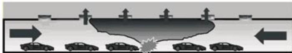
Figure 2 - Stratification de la fumée en ventilation transversale [11]
