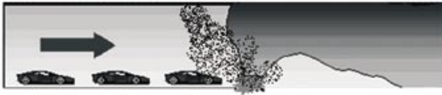
Figure 1 - Déplacement de la fumée en ventilation longitudinale [11]
