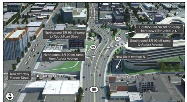
Figure 5 – Accès Nord et Sud au tunnel et échangeurs
