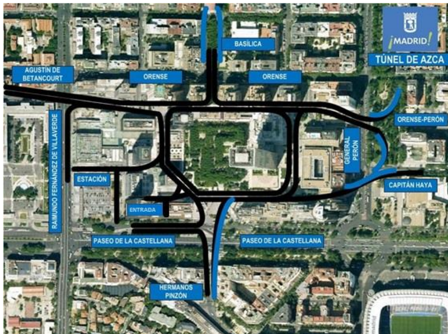
Figure 1 – plan des rampes d'accès et de sortie du tunnel d'Azca
