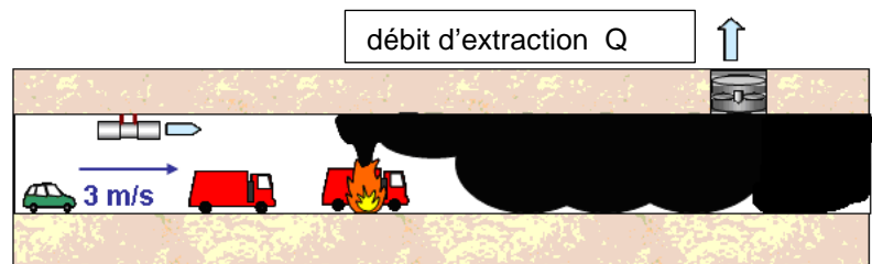
Figure 5 – fonctionnement de la ventilation lors d'un incendie
