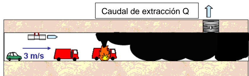
Figura 5 – Funcionamiento de la ventilación en caso de incendio
