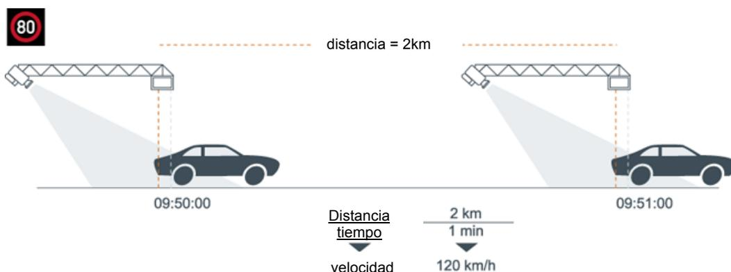
Figura 9 – Se calcula la velocidad media del vehículo en un tramo de la carretera
