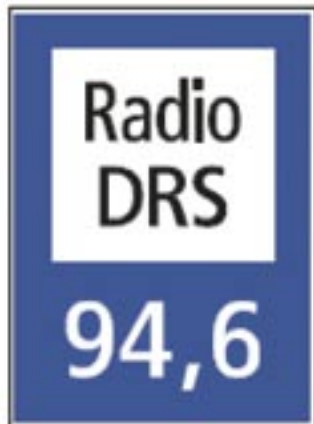
Figure 19 : panneau F14 de la convention de Vienne indiquant la fréquence qui peut être captée dans le tunnel
